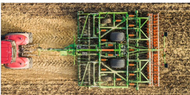
Uma haste corre atrás de cada roda para soltar os rastros das rodas
