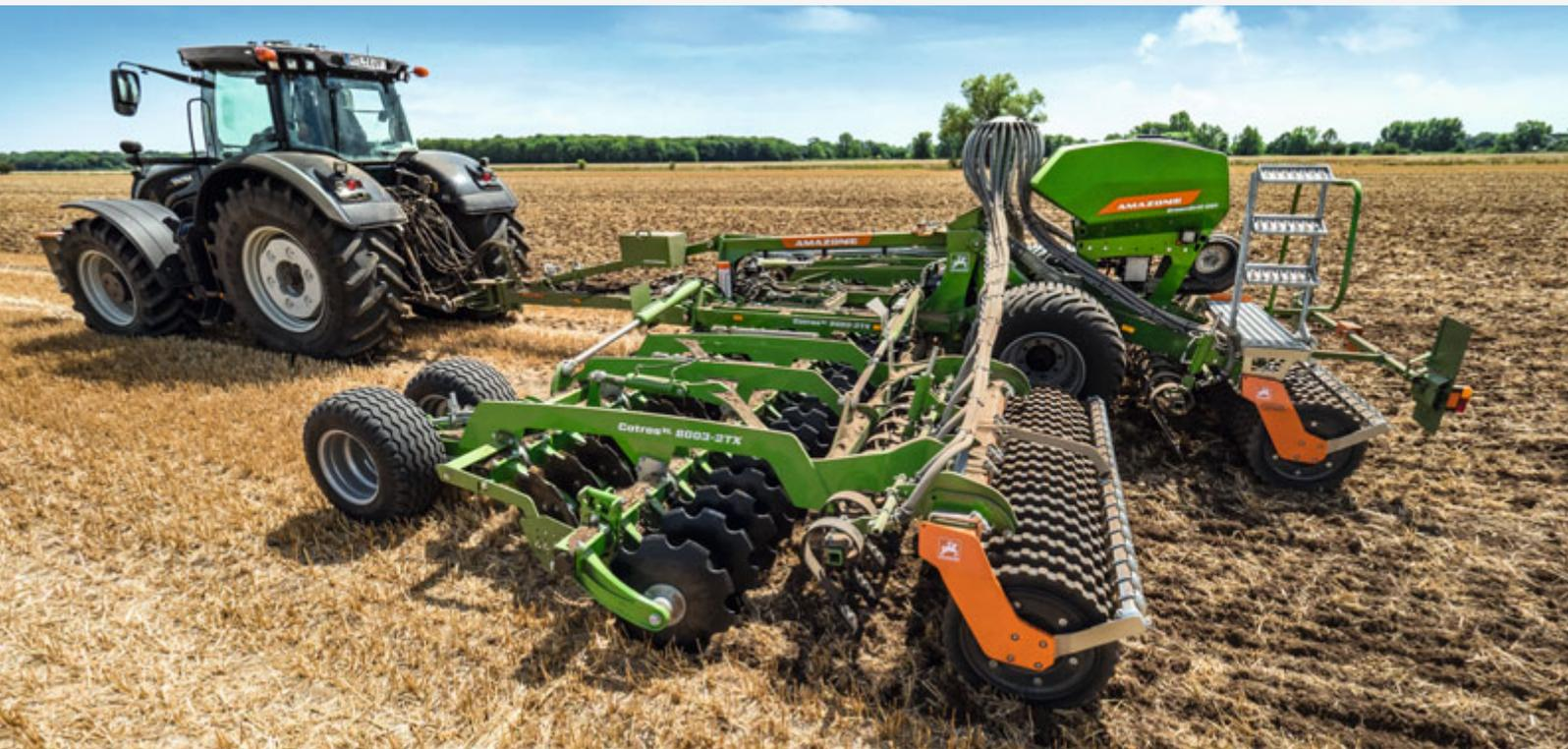
Catros<sup>XL</sup> 8003-2TX na incorporação de resteva com GreenDrill montada para semeadura de cultivos de cobertura
