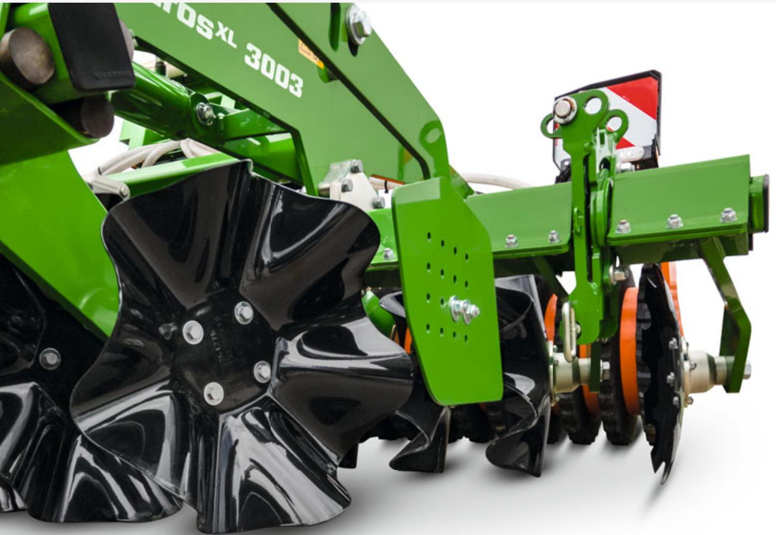
O X-Cutter-Disc funciona com baixa profundidade de trabalho em toda a superfície graças, ao seu perfil ondulado especial
