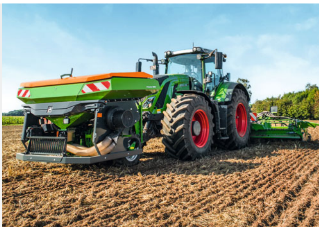
Tanque montado frontal FTender 1600 com capacidade de depósito de 1.600 l
