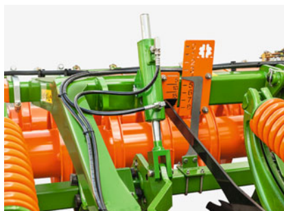
Cilindro para a regulação da profundidade da unidade de nivelamento
