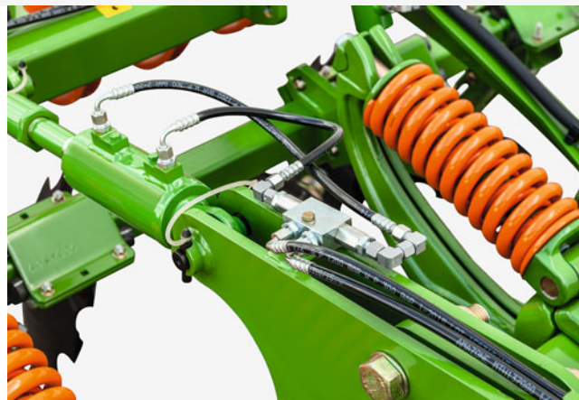
Cilindro para ajuste de profundidade do campo de hastes
