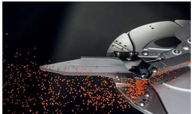
AutoTS – Ajuste da palheta para distribuição em bordadura
