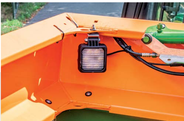
Luzes de trabalho no interior do depósito
