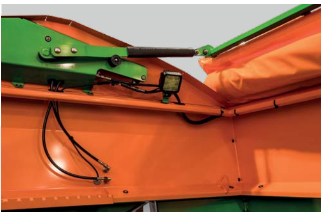
Luzes de trabalho no interior do depósito
