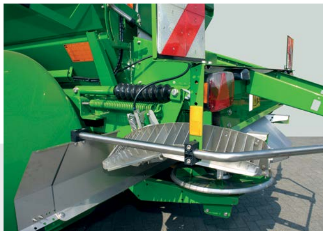
Sistema de distribuição em bordadura Limiter basculado para cima
