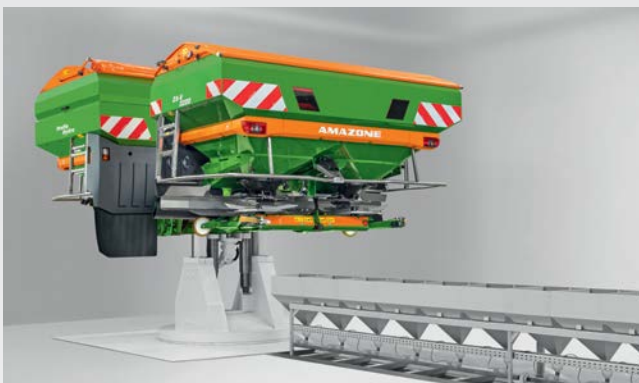
Pavilhão de testes moderno para distribuidores de fertilizante
