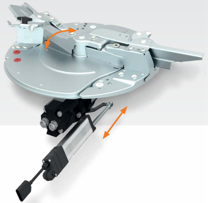
AutoTS – Ajuste da palheta guia para distribuição em bordadura
