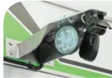
Sistema de iluminação e câmeras integradas.
