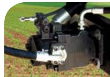
Bomba hidráulica sistema load sense.
