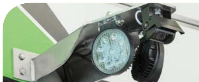
Sistema de iluminação e câmeras integradas.
