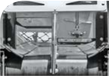
Comporta dupla com desligamento de seção (opcional) .
