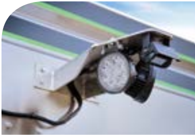
Sistema de iluminação e câmeras integradas.
