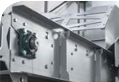
Estrutura da esteira removível em aço inox.
